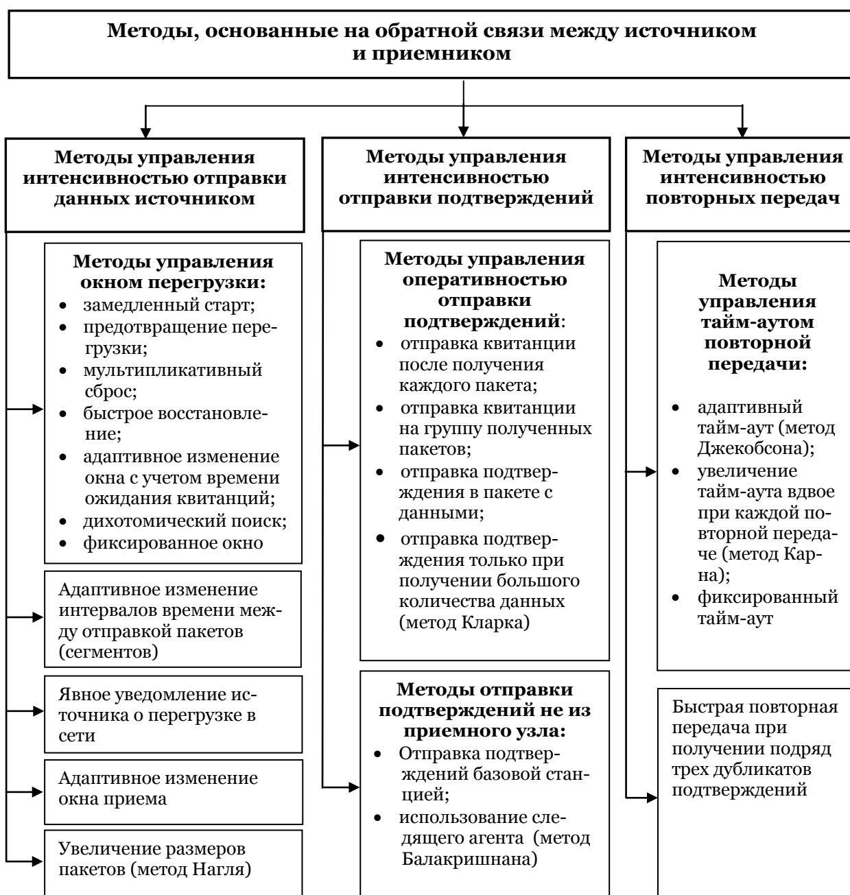
Рис. 2. Классификация методов обеспечения QoS, основанных на обратной связи между источником и приемником
