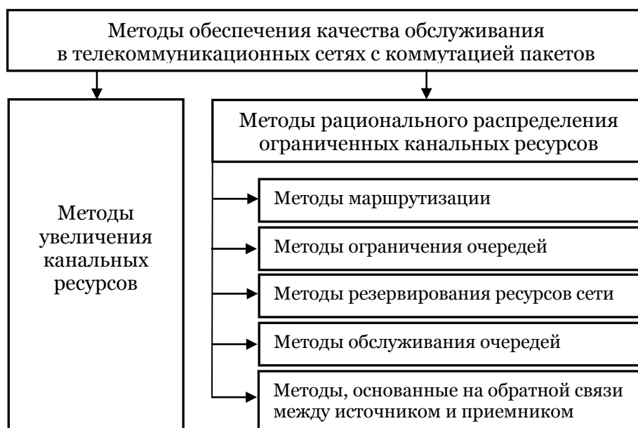
Рис. 1. Классификация методов обеспечения QoS
